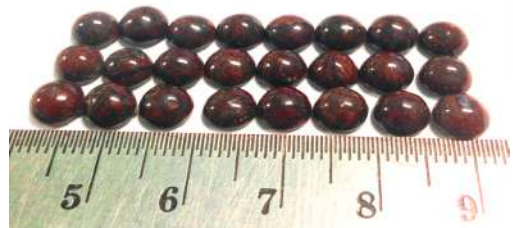
รูปที่ 1 ตัวอย่างหินไรโอไลต์ (Rhyolite) ชัดมัน รูปทรงกลมสีแดงคล้ำ ทึบแสง ขนาด 6x6x3.76 มิลลิเมตร จำนวน 14 เม็ด มีน้ำหนัก 1.11 – 1.14 กรัม ค่า ถ.พ. เท่ากับ 2.72 – 2.74 ที่ใช้ประกอบในชิ้นงานเครื่องประดับ
