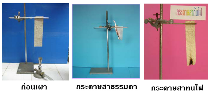
รูปที่ 2 การทดสอบการทนไฟ
