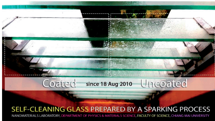
รูปที่ 5 ภาพถ่ายเปรียบเทียบระหว่างกระจกที่ไม่ได้เคลือบกับกระจกที่เคลือบด้วยฟิล์มอนุภาคนาโน \text{TiO}_2 โดยใช้กระบวนการสปาร์ก โดยเคลือบเมื่อวันที่ 18 สิงหาคม พ.ศ. 2553 และตั้งไว้เพื่อทดสอบในสภาพแวดล้อมจริงจนถึงปัจจุบันนี้
