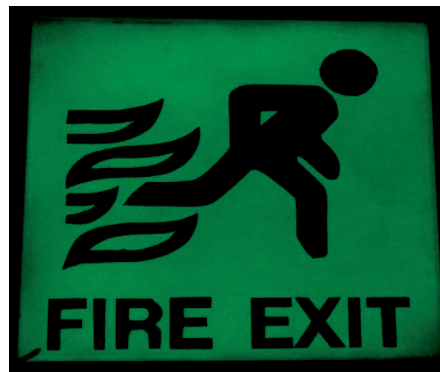
ภาพที่ 5 ตัวอย่างแผ่นกระจกที่เคลือบด้วยสารเรืองแสง ZnS:Cu โดยผ่านกระบวนการลามิเนต เพื่อป้องกันการเสื่อมสภาพของการเรืองแสง [9]
